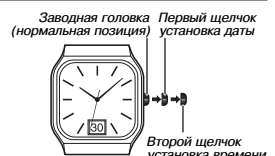
Первый щелчок установка даты Второй щелчок установка времени
